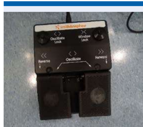
Figura 6. Switch de pedales para accionar el sistema de la pieza de mano; con él se calibra la ventana de corte y es factible cambiar la dirección de la rotación, así como el tipo de cuchilla en el caso del sistema 5C.
